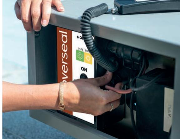
4) Identifizieren Sie den Handbedienungsflansch und stecken Sie die bei der Installation mitgelieferte Verlängerung hinein.
