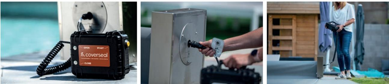
Um Ihr Steuergerät zu laden, müssen Sie zunächst den Ladeanschluss identifizieren und dann das Ladegerät wie auf dem Foto gezeigt anschließen. Die LEDs „Power“, „Slow“ (bzw. „Normal“) und „24V“ leuchten auf. Sobald der Akku vollständig geladen ist, leuchtet auch die LED „100%“.
